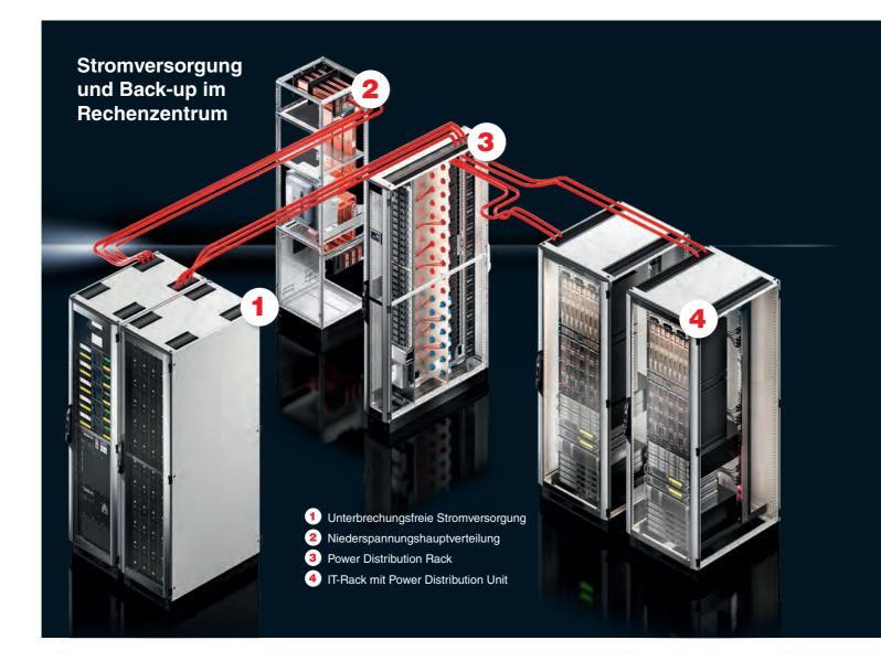
Dazu zählen eine redundante Stromzufuhr von zwei verschiedenen Energieversorgungsunternehmen (EVU) oder, wenn nicht möglich, von unterschiedlichen Umspannanlagen, redundante Transformatoren und Niederspannungshauptverteiler.
