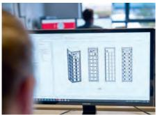
Sicher geschützt: Das klimatisierte Outdoor-Gehäuse sorgt für optimalen Betrieb der Batteriespeicher (oben). Effizient geplant: Durch die 3D-Aufbauplanung mit Eplan Pro Panel entsteht der digitale Zwilling der Anlage.
